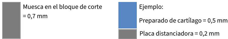
Fig. 3: Grosor del preparado de cartílago = 0,7 mm menos el grosor de las placas espaciadoras
